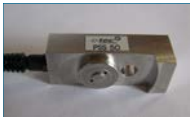
Piezoquarzsensormontage am Pressenrahmen
