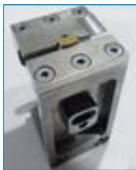
Eingespannter Crimp im Probenhalter
