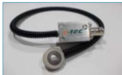
Piezoquarzsensoreinbau in die Crimppresse
