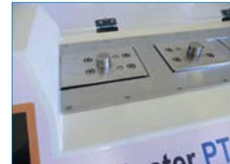
Schnellwechsel-System für Probenhalter
