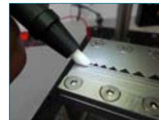
Feinpolieren der Schnittfläche eines Crimps
