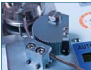
Ziehen bis Abriss
