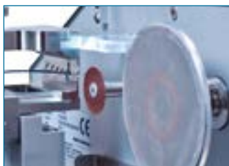
Schneiden und Schleifen in einem Arbeitsgang
