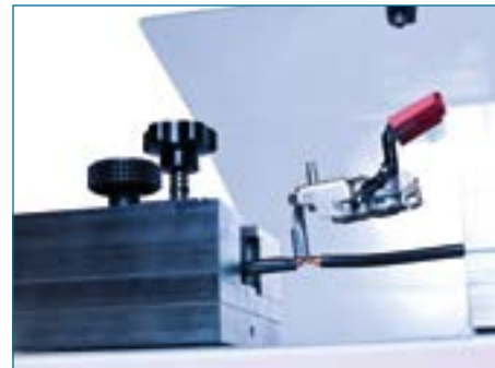
Prüfung von Kabeln mit einem größeren Durchmesser, z. B. Leiter-Ausziehverhalten an einem Batterieklemmen-Crimp
