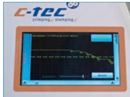
Darstellung der Messkurve in Echtzeit direkt auf dem Gerätedisplay
