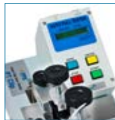
Anzeige der maximalen Zugkraft auf dem Display
