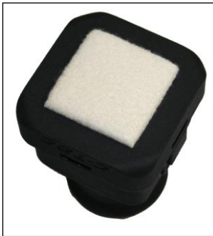
Unterseite des Polierwerkzeugs mit eingelegtem Polierpad
