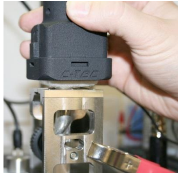
Einfaches Feinpolieren mit dem Polierpad
