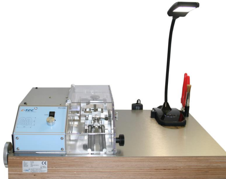
ML 3300 Anlage zum präzisen Trennen und Schleifen von elektrischen Crimpverbindungen
