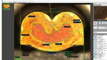
Dokumentation der Crimpschlibfbilder nach DIN EN ISO 1463 mit der Analysesoftware X-Scan
