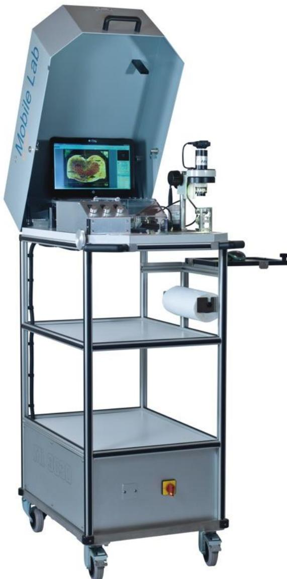
Das mobile **Schliffbildlabor ML 3030** wurde konzipiert, um die Anforderungen einer schnellen und präzisen Herstellung von Crimpschliffbildern im Fertigungsbereich zu erfüllen. Durch seine mobile Bauweise und Akkubetrieb kann das **Mobile Lab ML 3030** flexibel überall im Fertigungsbereich eingesetzt werden.
